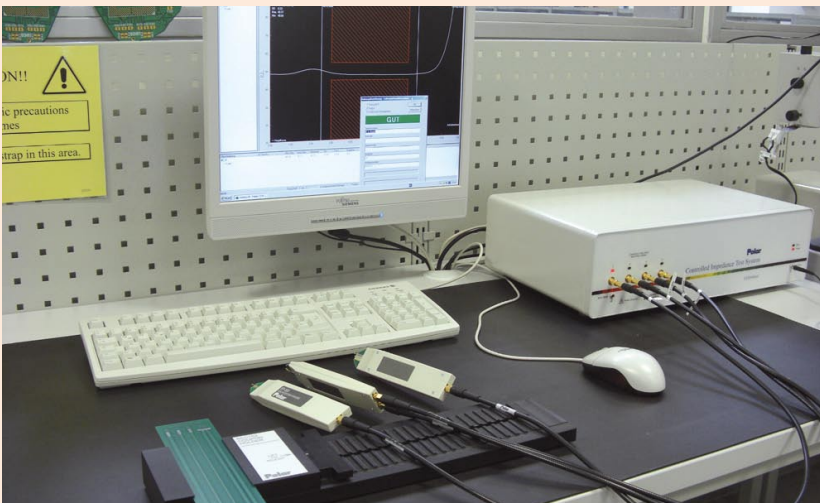
CAM-Arbeitsplatz bei CONTAG mit der Impedanzberechnungs-Software von Polar. Die Software verfügt über knapp hundert unterschiedliche Impedanzmodelle
